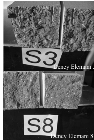
Şekil 5. Deney Elemanları Kırılma Düzleminde Örnekler (Figure 5. Example of Specimens Failure Plane)
