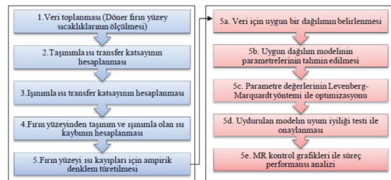
Şekil 1. Döner fırın sistemi ısı analiz akış diyagramı (Flow diagram of rotary kiln system thermal analysis)
