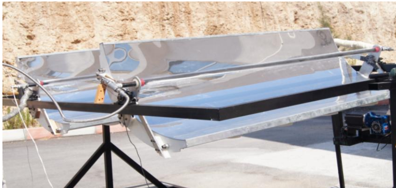
Şekil 5. İmalatı yapılan parabolik oluk tipi güneş kollektörünün görünüşü (View of the manufactured parabolictrough-type solar collector)
