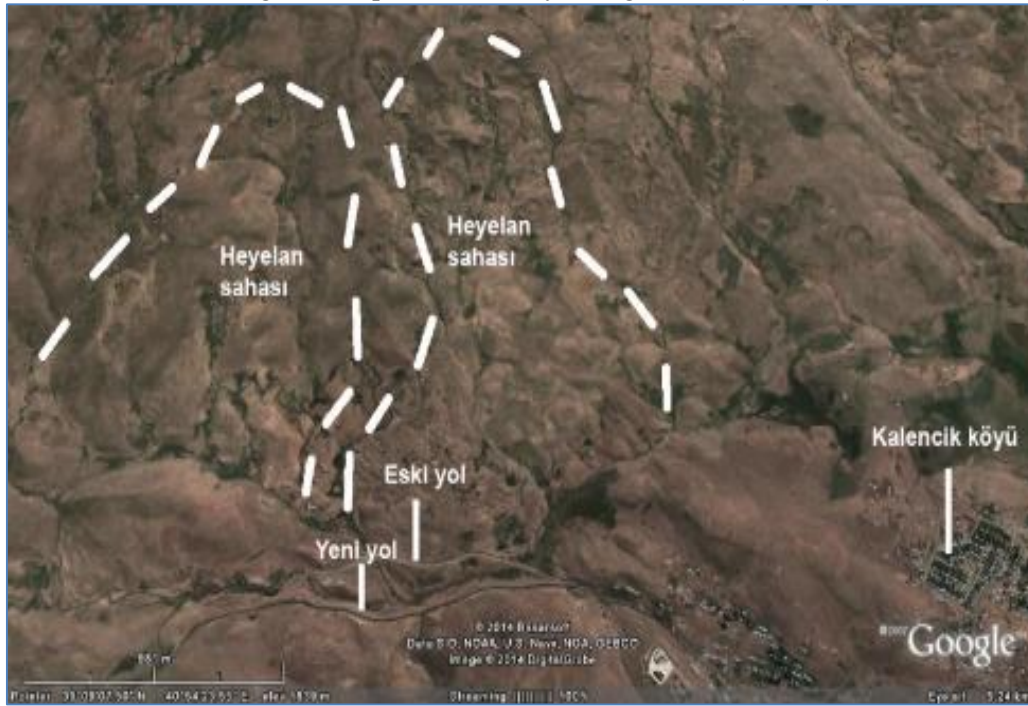
Şekil 2. Karlıova Havzası'nda eğim değerlerinin düşük olduğu Kalencik köyü yakınlarında (Bingöl) karayoluna zarar veren heyelanlar meydana gelmektedir (Google Earth'den)
