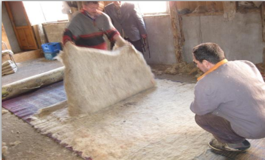
Resim 8. Kepenek Yapımında Katlama Kapama
