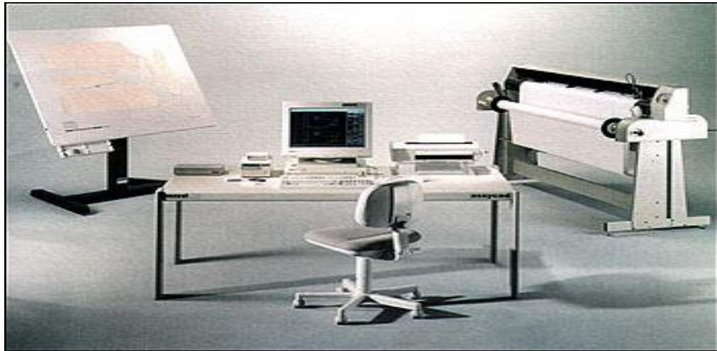
Şekil 2. B.D.T. Sistemlerinin Ana Elemanları
