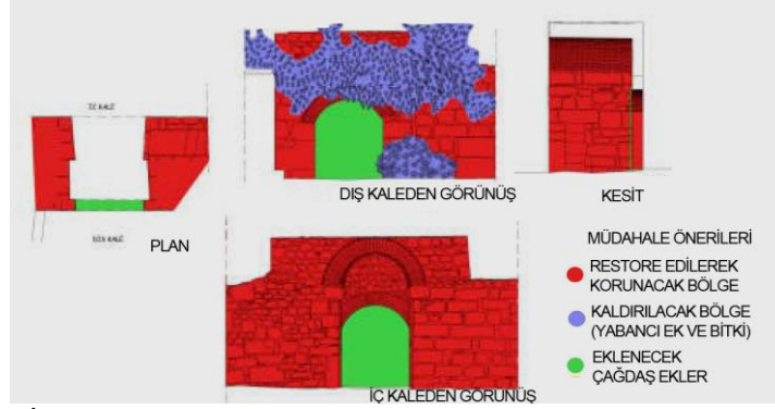
Resim 36. İç kale'den Dış kale'ye Geçiş Müdahale Kararları, 7 Nolu Kapı.
