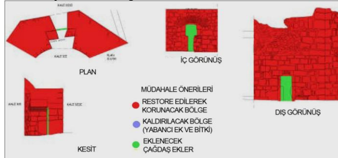
Resim 33. Güneybatı Burç Kapısı Müdahale Kararları, 3 Nolu Kapı
