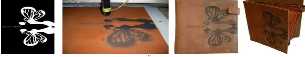
Şekil 8. Grafik Öğrenci Uygulaması Görsel Çözünürlük 600 dpi, Güç: 100, Hız: 50 Kompakt Malzeme Üzerine Lazer Aşındırma
