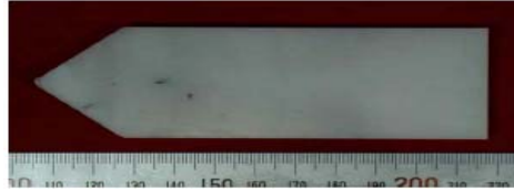
Şekil 2. Levha biçimli Al_2O_3 /YAG ingot [13]
