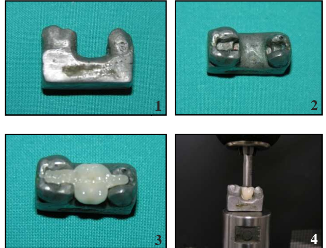
Resim 1: Test örneklerinin basma kırılma direnci deneyinde kullanılan metal modelin önden görünüşü.
