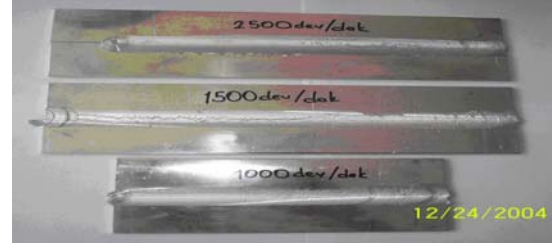
Şekil 9. 120 mm/dak kaynak ilerleme hızında devir sayısına bağlı olarak meydana gelen yüzey görüntüleri
